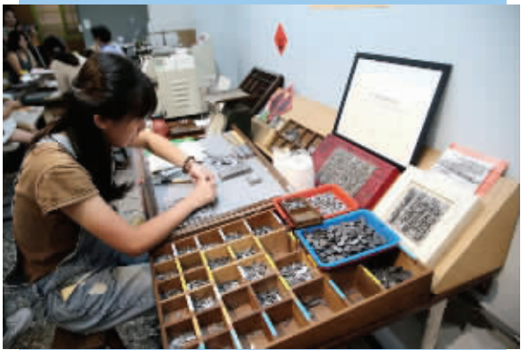
台北太原路上的“日星铸字行”内，工作人员正在进行铅字排版。该铸字行开办于1969年，专门制作铅字及铅字印刷，是台北仅存的一家铸字行(张远摄)
